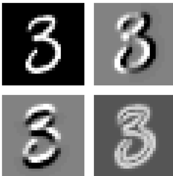
FIG. 6.3 : Cette figure montre le chiffre d'origine, les deux vecteurs tangents horizontaux et verticaux et le vecteur tangent d'épaississement
